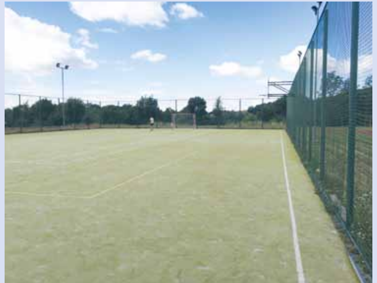
V těchto místech proběhne rekonstrukce povrchu hřiště dle požadavků školy. Bude zde položen trávník tzv. třetí generace.
